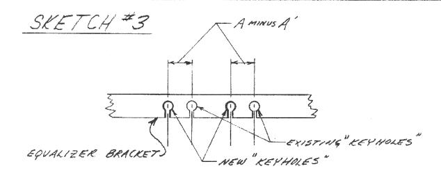
\* IF AN EFFORT REDUCTION OF 3337. IS DESIRED, THE NEW MECHANICAL ADVANTAGE SHOULD EQUAL 1.33 TIMES THE OLD ADVANTAGE RATIO; THUS KNOWING ONLY A, A' IS GIVEN BY THE EXPRESSION:
